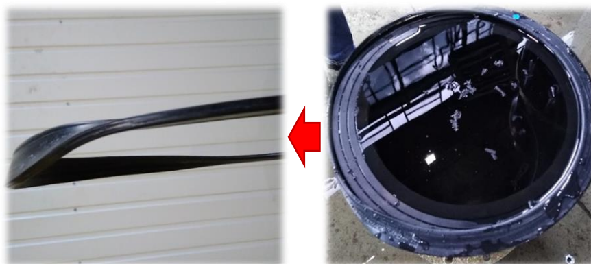
Zdjęcie 5. Widok wyciągniętej uszczelki po rozkręceniu połączenia i zdjęciu kształtki wtryskowej
