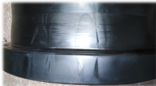
Zdjęcie 10. Tuleja wtryskowa. Powierzchnia w okolicach deformacji - strona zewnętrzna tulei.
