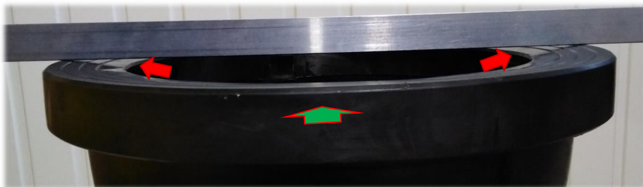
Zdjęcie 6. Deformacja kołnierza na całym obwodzie tulei wtryskowej
